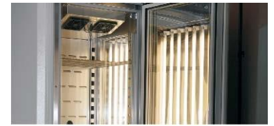
FYT DS – zářivky ve dveřích a stěnách komory
